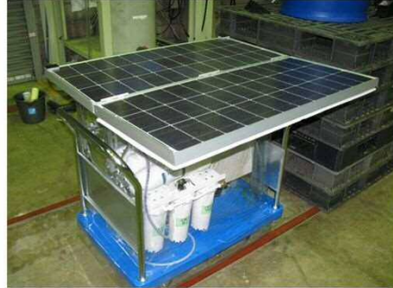
太陽光発電・小型脱塩浄水装置(PVRO)
