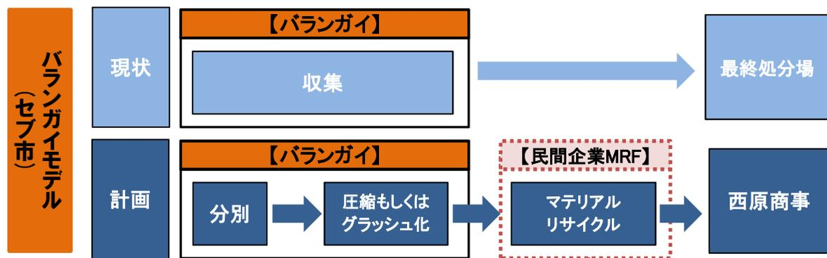
これまで埋立処分されていた軟質系廃プラスチックを住民が分別・洗浄し、それを balan-gai が買い取り(1PHP/kg想定)、 balan-gai にてグラッシュ化した製品を民間企業MRFに集約し、西原商事が買い取るモデル。西原商事は、プラント購入への助言及びプラントの balan-gai 設置・運転に関する技術支援を実施。
